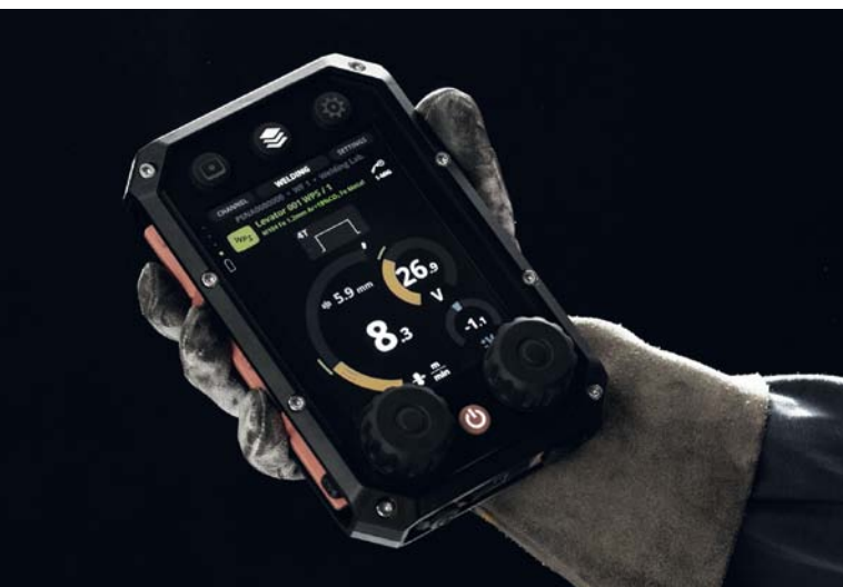
Der X8 MIG Welder von Kemppi bietet neueste Technologie. Mit der Software WeldEye werden WPS digital übermittelt, das Control Pad zeigt an, ob die Werte beim Schweißen eingehalten werden. Seite 26
