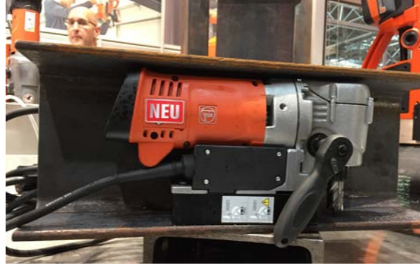
Die neue Winkelbohrmaschine passt genau in einen Stahlträger mit einer Steghöhe von 170 Millimetern.
