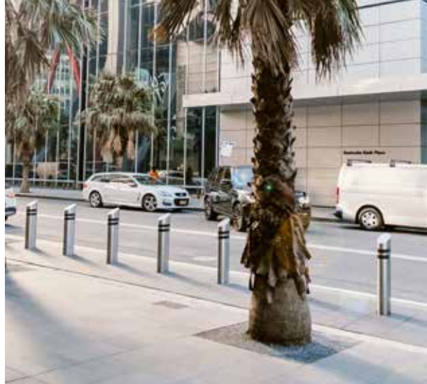
Sicherheitspoller werden im Innenstadtbereich zum Schutz vor Fahrzeugattacken eingesetzt.
