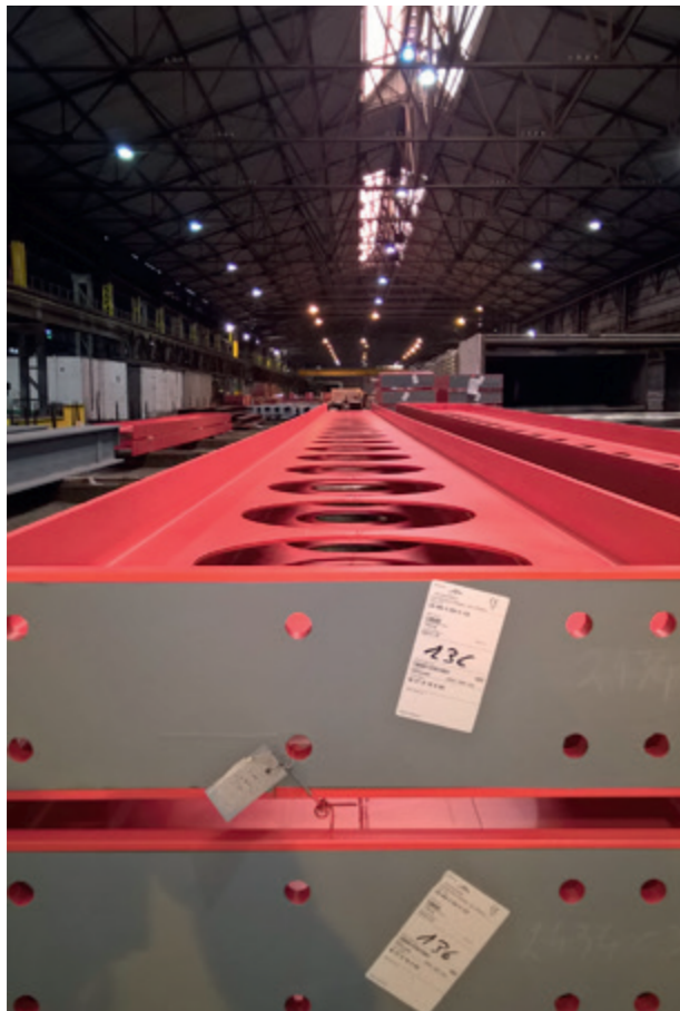
Thermomechanically rolled steel grades are marked M: The photo shows S355J2 + M profiles. Thermomechanisch gewalzte Stahlgüten werden mit M gekennzeichnet: Auf dem Foto handelt es sich um S355J2 + M Profile.
