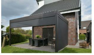
Die Bioclimatics-Modelle Maestro haben drehbare Lamellen.
