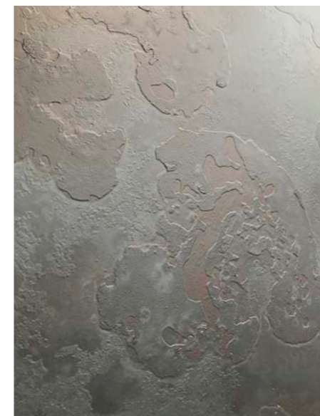
Eine harte Zunderschicht verleiht dem Stahl eine besondere Oberflächenstruktur.
