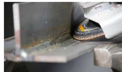
Die neue Jumbo Longlife TRIM Scheibe ist für Kehlnähte besonders geeignet.
