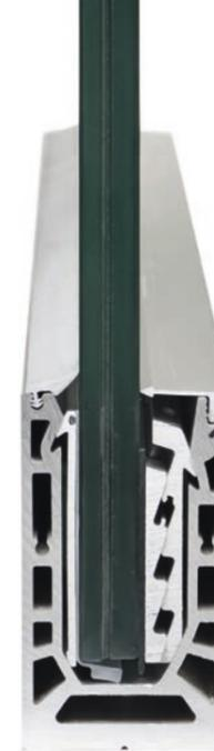
Glasscheiben bis zu einem Meter Höhe können am oberen Rand ca. 40 Millimeter in jede Richtung ausgerichtet werden, die Profیلneigung kann dabei maximal ca. 2,5 Grad betragen. Außerdem ist das System so konzipiert, dass alle Montagearbeiten sicher von einer Seite ausgeführt werden können. Das Alu-Profil kann in allen RAL Classic-Farbtönen pulverbeschichtet werden. Beleuchtungssysteme und Handläufe ergänzen das Produktportfolio.
