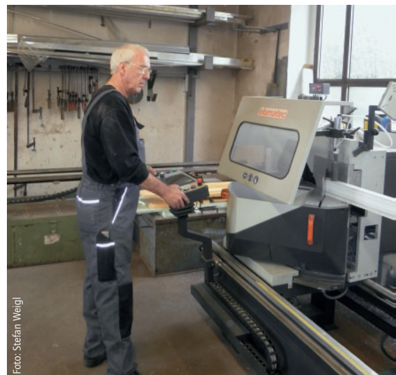
Foto: Stefan Weigl Mit einer automatischen Säge sind Serienfertigungen für die Industrie möglich
