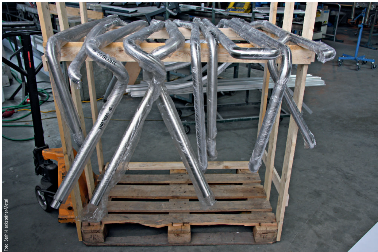
Im Dormbiegeverfahren gebogene Handläufe aus Edelstahl
