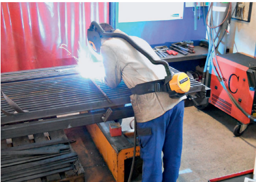
MAG-Schweißen eines Rechenfeldes für Wasserkraftanlagen
