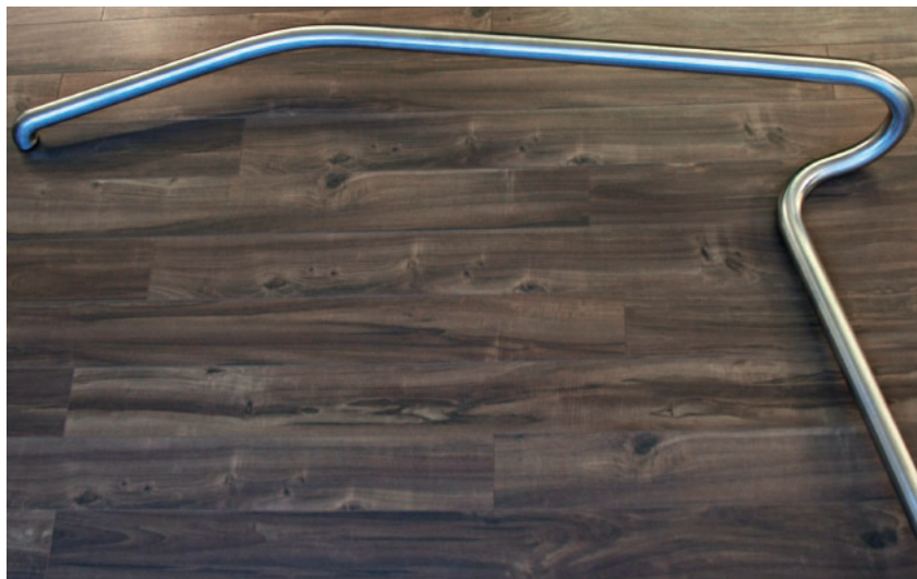
Fertigstellung einer Treppe im 3D-Walzen-Biegeverfahren
